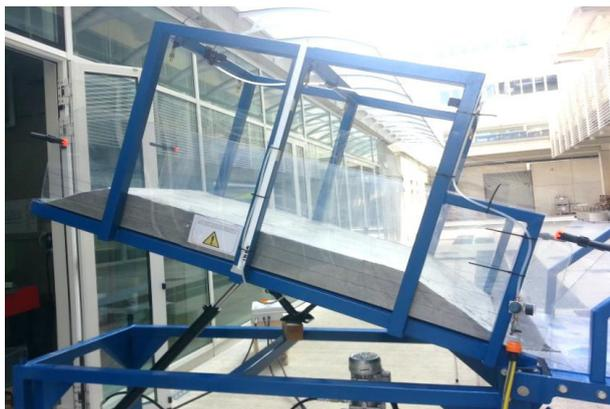
Fig. 1 - Simulatore di frana e modello in scala.
